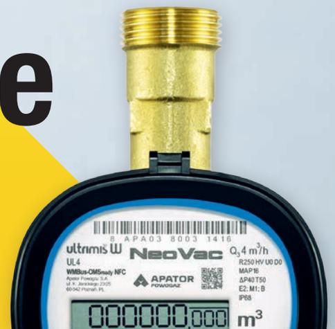
Der NeoVac Ultrimis W Ultraschall-Wasserzähler basiert auf neuester Technik, verfügt über keine beweglichen Teile und garantiert die höchste Messqualität bis R800. Der Gehäuseschutz IP68 und die Einbaumöglichkeit in jeder beliebigen Betriebsstellung bieten maximale Flexibilität bei Einsatz und Betrieb. Modernste Kommunikationstechnologien wie Wireless-M-Bus und NFC machen manuelle Zählerauslesungen und Verbrauchsschätzungen überflüssig.
